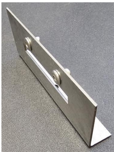
Рис.38 Ремонтный профиль РП1 с установленными в проектное положение заклёпками стопорами 4x8, нерж. 1.2 мм
