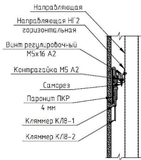
Рис.27 Установка с прокладкой ПКР
