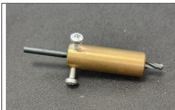
Рис.22. Ограничитель глубины сверления
